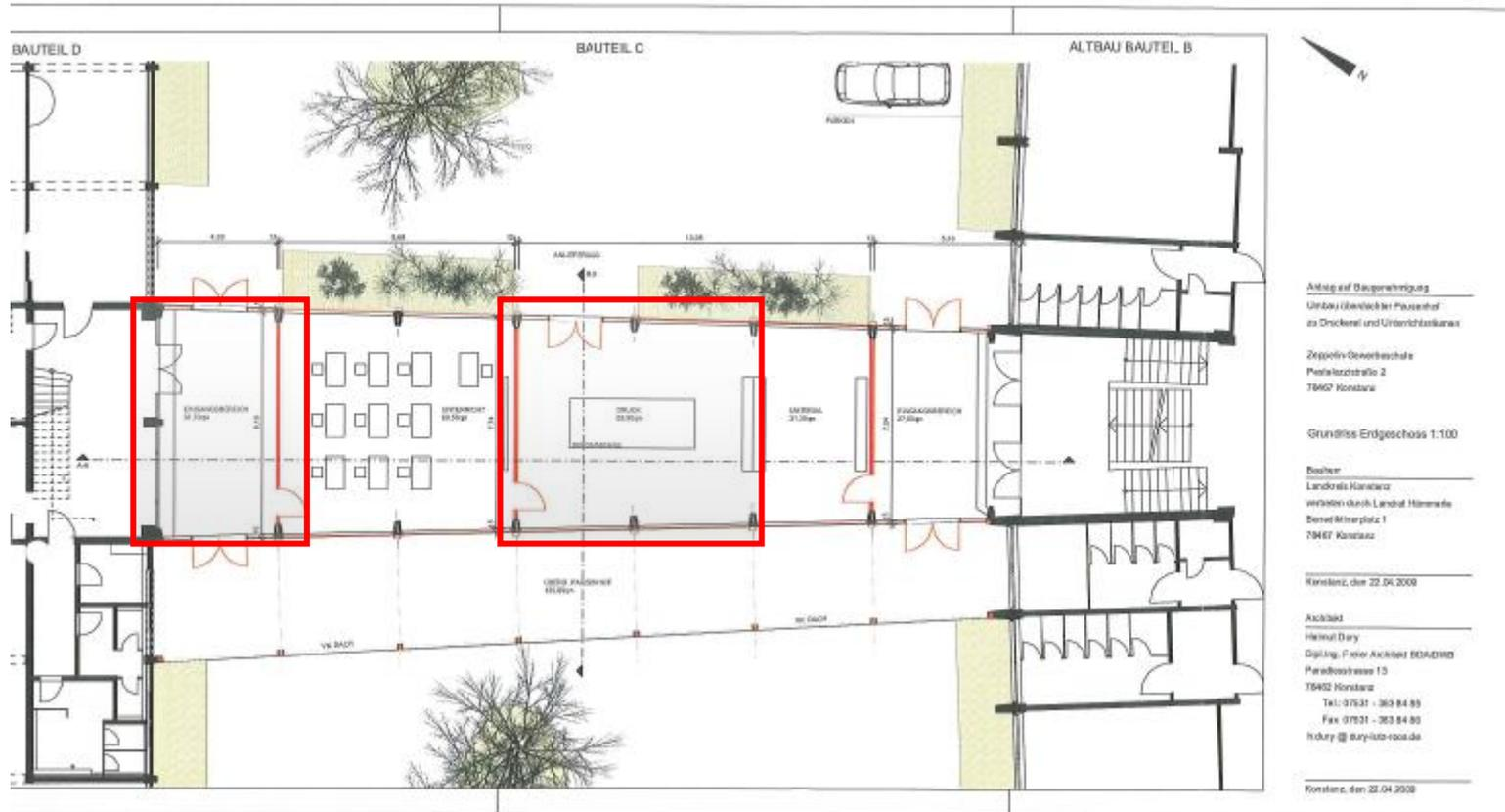
Auszug Grundriss EG, ohne Maßstab, markierter Bereich: Druckmaschine und Freilegung Fernwärmeleitung
