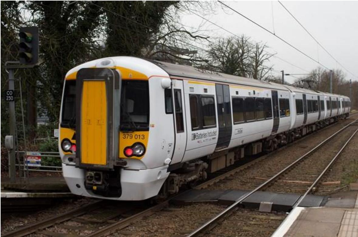
Abbildung 11: Bombardier Electrostar-Baureihe 379 im Batterie-Testbetrieb (Network Rail 2017)
