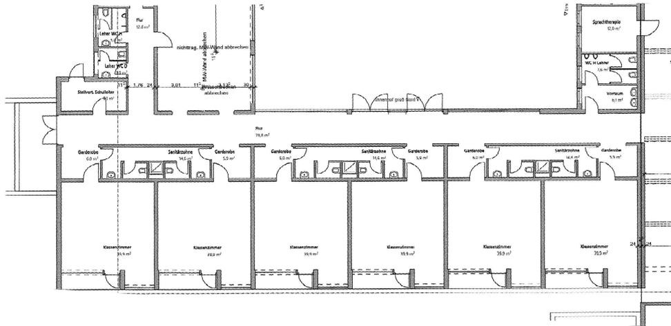
**Umbauplan:** Vergrößerung der Klassenzimmer von 39,9 m<sup>2</sup> auf 54 m<sup>2</sup> und Schaffung von dazwischenliegendem Differenzierungsräumen (**Legende: gelb = Rückbau rot = Neubau**)
