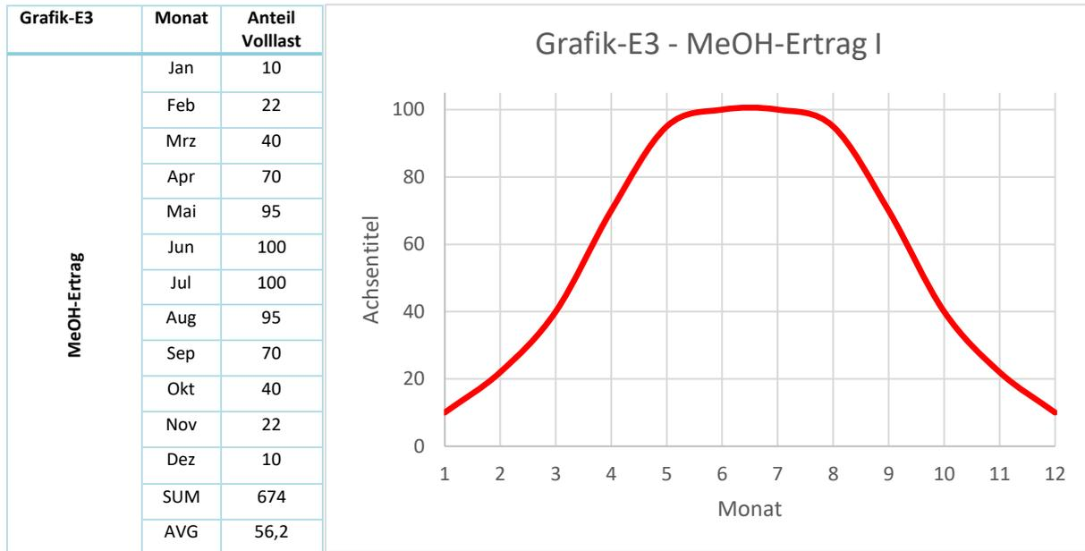
Abbildung 12: Grafik-E3 zeigt den möglichen Ertrag einer Methanolproduktionsanlage, in Verbindung mit Photovoltaikanlage.
